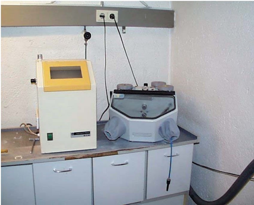
Bild 4: Sandstrahlgeräte zur Reinigung von metallischen Kleinteilen( z.b. Teleskopbrücken )
